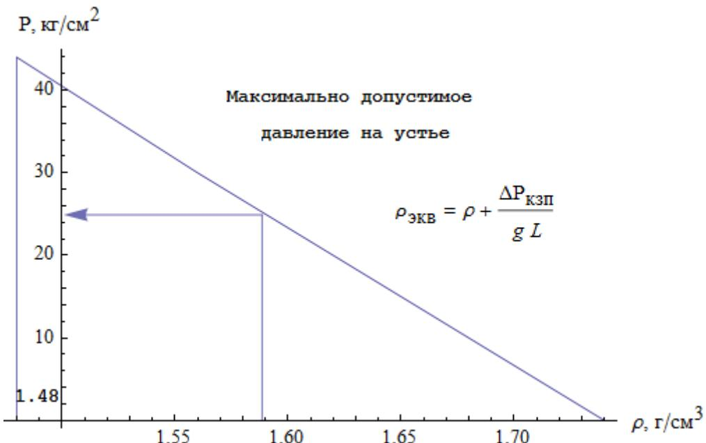
График зависимости МАASP от плотности бурового раствора
