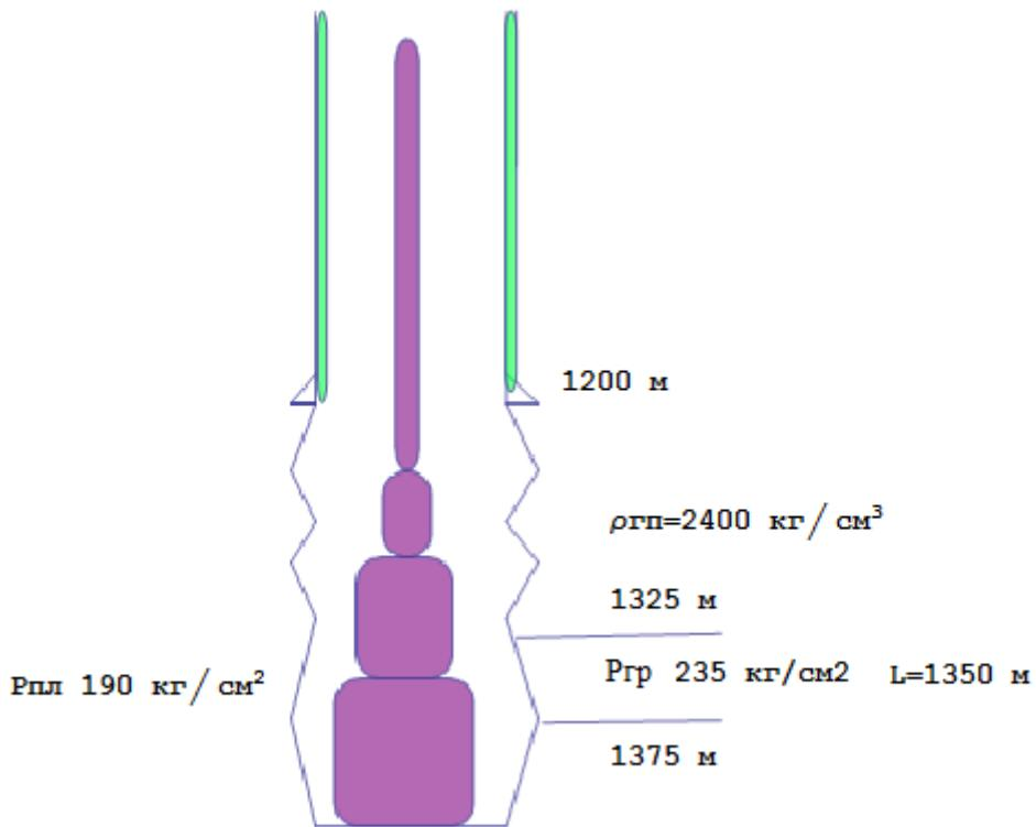
Рис.1. Схема конструкции скважины на текущий период времени
